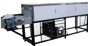
**Конвейер охлаждающий ОК-1-1 (ОК-2-1)** предназначен для механизации процесса охлаждения декорированных кондитерских изделий на предприятиях пищевой промышленности.
